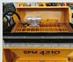
5 Tolva diseñada para shotcrete
